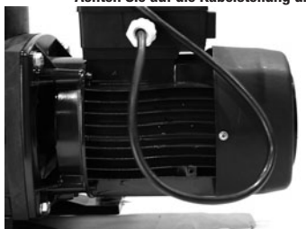
RICHTIG! Wassereintritt über Anschlusskabel wird verhindert
